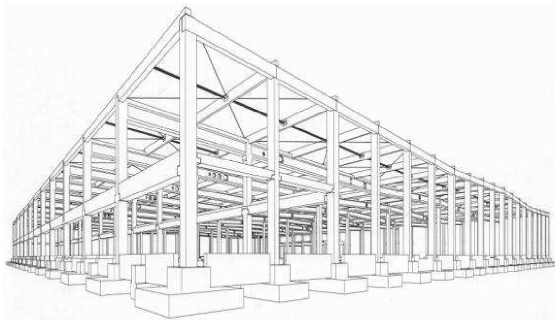
4. ábra. Vasbeton vázszerkezetek erősítése acél-szélráccsal
